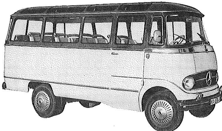
**Diesel-Motor · 4 Zylinder · 4-Takt · 55 PS bei 4350 U/min**
