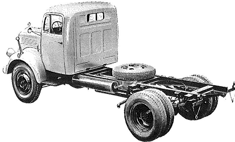
**Diesel-Motor · 6 Zylinder · 4-Takt · 100 PS bei 3000 U/min**
