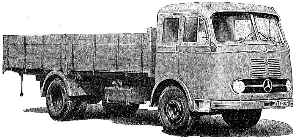
**Diesel-Motor · 6 Zylinder · 4-Takt · 192 PS bei 2200 U/min**
