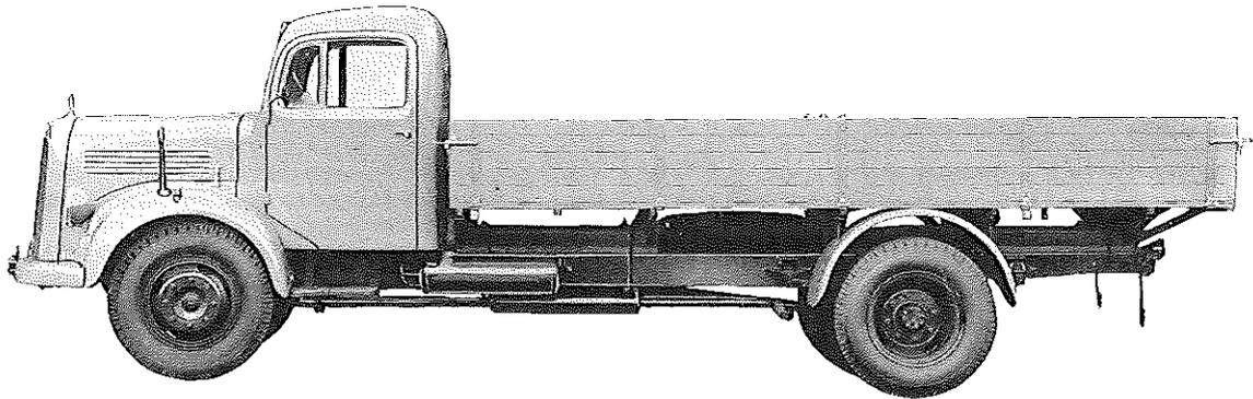
**Diesel-Motor · 6 Zylinder · 4-Takt · 100 PS bei 3000 U/min****Nutzlast: max. 5,095 t****Triebwerk****Motor**
