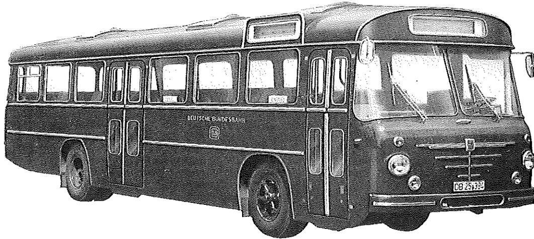
**Diesel-Motor · 6 Zylinder · 4-Takt · 192 (150) PS bei 2000 U/min**
