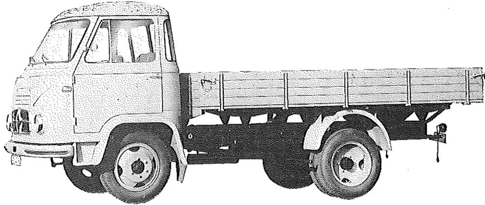
**Diesel-Motor · 4 Zylinder · 4 Takt · 70 PS bei 2800 U/min.**
